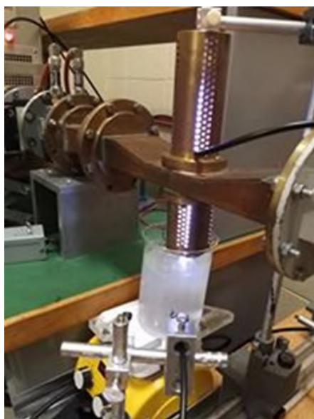
Montage expérimental du traitement par plasma d'eaux contaminées (Collaboration Cégep de Saint-Laurent et Université de Montréal)
